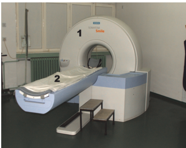
Слика 1. КТ апарат Somatom Smile (Siemens): 1) Гентри, 2) Кревет за пацијента
