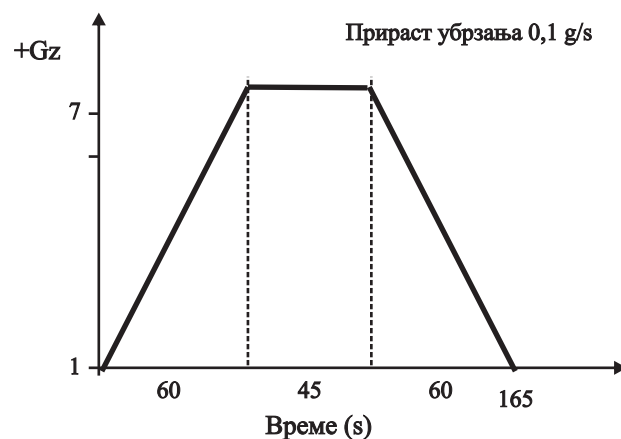
Слика 1. Приказ модела теста линеарног нарастања +Gz убрзања за експерименталне животиње
